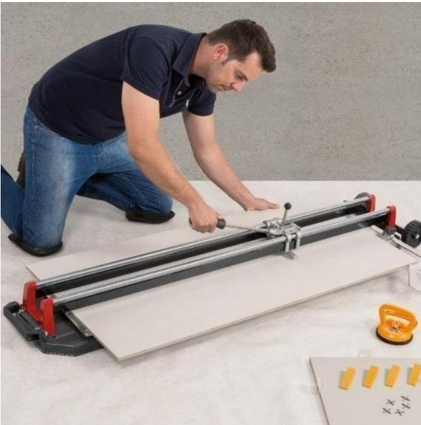
4. Se realizan los cortes de los pisos con herramientas manuales, este tipo de herramienta esta ocasionando mucho desperdicio.
