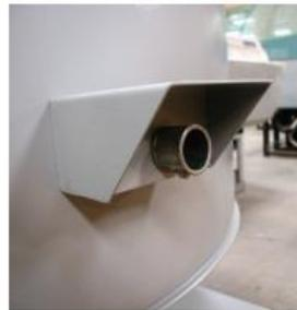
Ducto para conexiones eléctricas.
