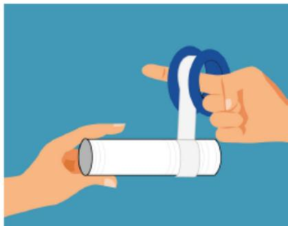
Las piezas de PVC que sean para enroscar o tengan partes lisas que necesiten mayor refuerzo, se recomienda colocar 10 vueltas de cinta de teflón, para evitar filtración.
