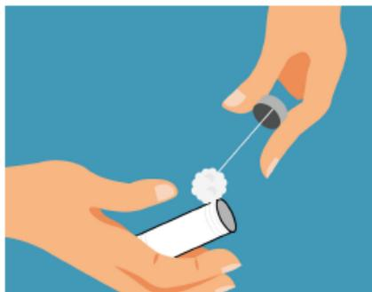
En cuanto a los tubos lisos, se recomienda reforzar su unión con pegamento especial para PVC, así evitar filtración. Mantener inmóvil la pieza de 3 a 5 segundos antes de manipular.
