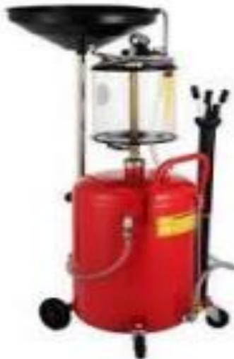
Capacidad de recolección 52L. Capacidad total de succión 4345L. Capacidad del embudo recolector 15 L. Dimensiones del embudo 58x25 cm. Para drenar por succión y gravedad aceite del motor, aceite de la caja de cambios, diferencial, transmisión, etc., en todo tipo de vehículos colocados en un elevador automático o fosa.
