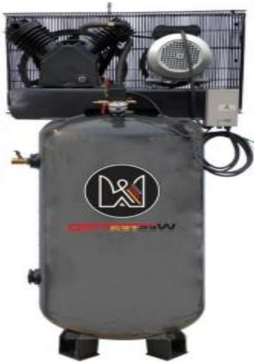
Compresor de aire vertical de dos etapas de nivel comercial de nivel de entrada. Esta unidad opera entre 140 y 175 PSI. La combinación del motor de bajo RPM de calidad comercial y de 2 pistones de servicio pesado, la bomba de compresor de aire alternativo de hierro fundido ofrece una cantidad increíble de volumen de aire y presión de aire a un precio muy bajo.
