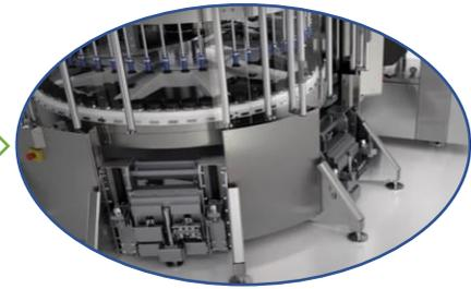
El mecanismo de corte servcontrolado y etiquetado garantiza una longitud de corte exacta. La posición del sleeve en el envase se ajusta en la estación de correas de forma continua.
