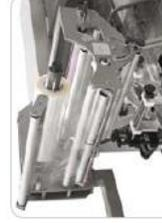
Portabobinas motorizado con amarre neumático
