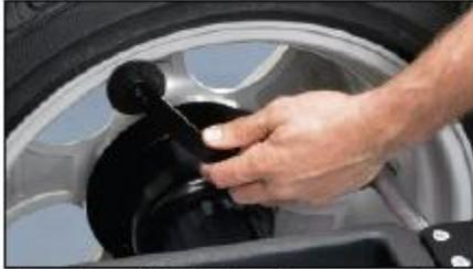
El brazo Dataset® interior determina exactamente dónde se ubicarán las pesas adhesivas y mide ruedas de hasta 30 pulgadas de diámetro (762 mm).
