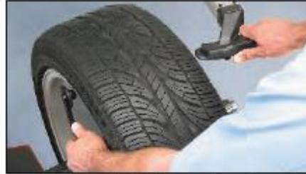
Los brazos Dataset® interior y exterior reducen el tiempo de medición al igual que errores en las medidas. Registren las medidas exactas a diferencia de otras balancadoras que utilicen medidas "nominales".
