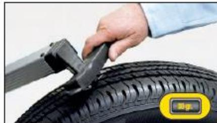
El modo ideal para los neumáticos de gran tamaño utilizados para vehículos 4x4 elevados. Resuelve problemas con exceso de pesas. Balancea utilizando parches con plomo en el interior del neumático (más cerca del centro de masa del ensamble). Esta característica permite balancear ruedas que otras máquinas no pueden.
