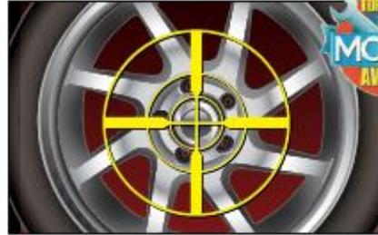
Esta característica **exclusiva de las balanceadoras Hunter**, asegura que la rueda está correctamente centrada en el eje de la balanceadora. Elimina problemas de repetibilidad en el balanceo y la necesidad de volver a balancear ruedas problemáticas.
