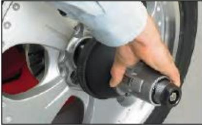
El AutoClamp opcional ahorra tiempo y esfuerzo. El adaptador del AutoClamp es posicionado y sujetado automáticamente. No tiene rosca ni tuerca, ni requiere del tiempo de enrosque.
