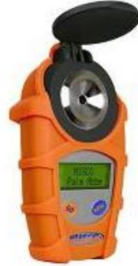
Refractómetro digital. El principio de medición se basa en la refracción de la luz (roto del latín: fractus) creada por la naturaleza y la concentración de los solutos (por ejemplo, el azúcar). Es por esto que un refractómetro mide indirectamente la densidad de los líquidos.
