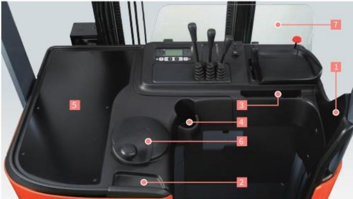
Dos agarraderas auxiliares, portavasos y lápices y el panel superior plano permiten una operación cómoda. La configuración redondeada ayuda a mantener el cuerpo en el interior.
