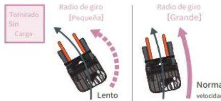
Velocidad del vehículo ajustada según radio de giro
