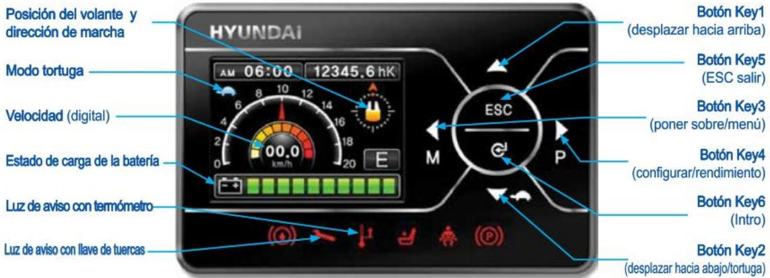
El monitor LCD de color con pantalla inteligente de 3,3 pulgadas permite que el operador pueda controlar fácil y eficientemente la máquina.
