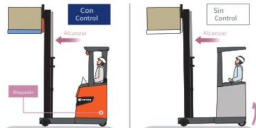
Sin reducción de capacidad a una altura de elevación de 4m
